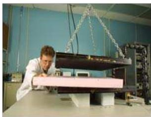
Compteur de flux thermique – conductivité thermique
