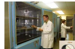
Compartiments de température et d'humidité constantes – diffusion de la vapeur d'eau
