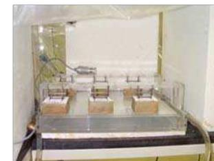
Immersion partielle – Coefficient d'absorption d'eau
