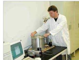
Appareillage de perméabilité à l'air – perméabilité à l'air
