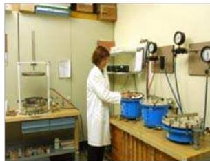
Appareillage de plaque de pression – isotherme de désorption
