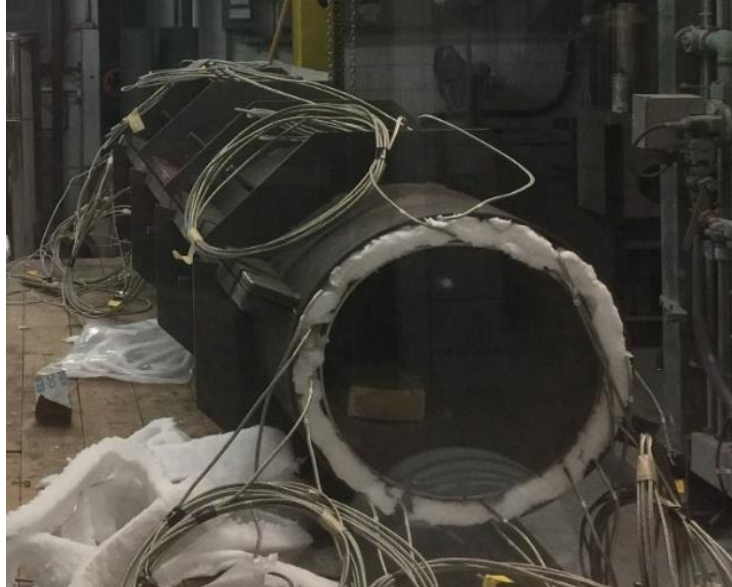
Figure 1 Calorimètre instrumenté avec des thermocouples sur l'enveloppe extérieure et l'enveloppe intérieure; le centre creux devant être rempli de matériaux isolants
