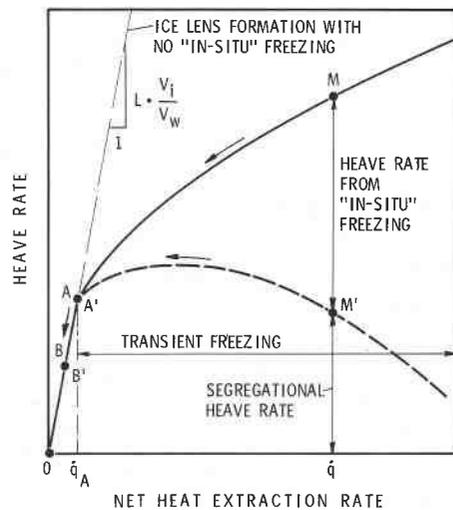
b) HEAVE RATE VS NET HEAT EXTRACTION RATE
