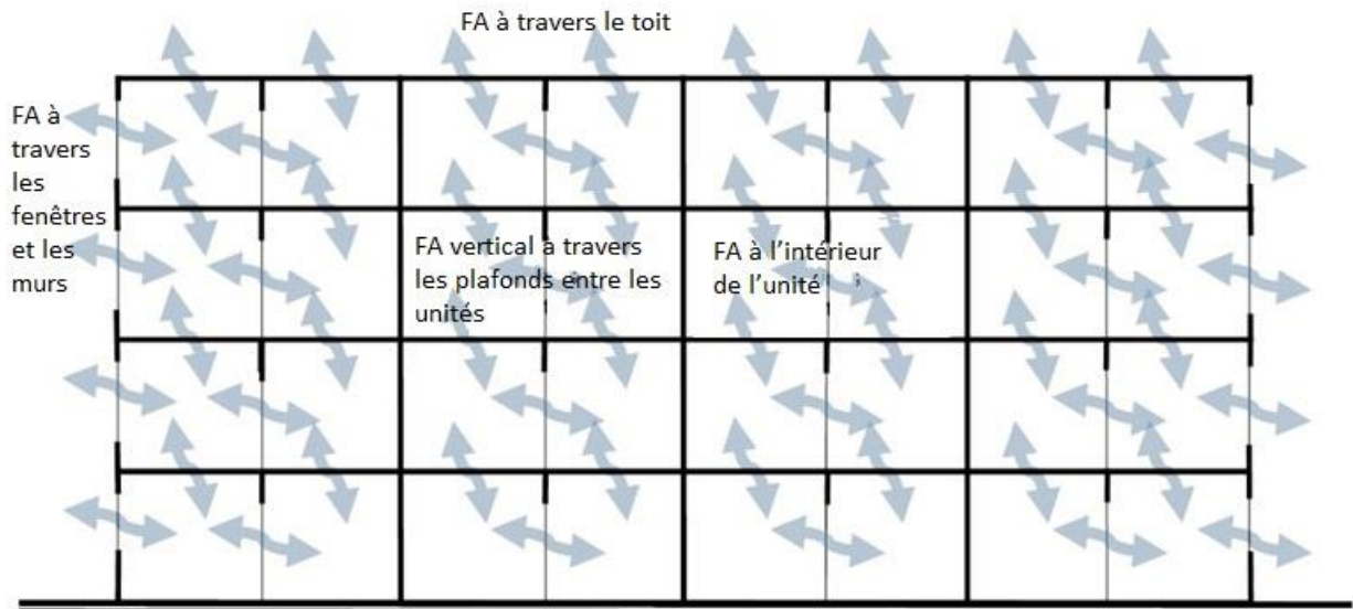
Figure 82. Échanges horizontaux et verticaux du réseau de flux d'air pour un modèle d'IRLM
