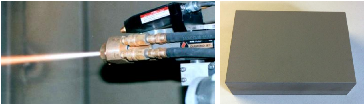
Figure 16 : Pistolet de projection HVOF en action (à gauche) et revêtement de cermet épais appliqué par HVOF sur un alliage d'aluminium à haute résistance (à droite).
