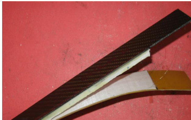
Figure 29: Des tests de pelage ont montré une défaillance dans le UHMWPE.
