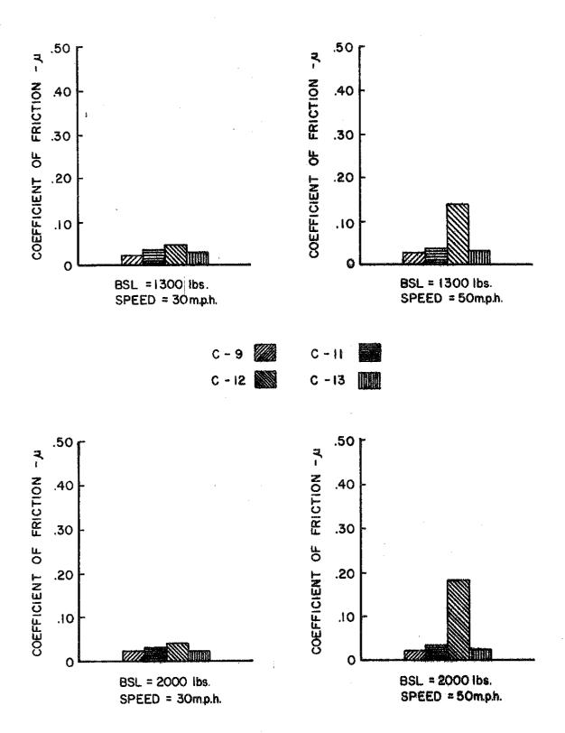
FIG. 2 COMPARISON OF FRICTION COEFFICIENTS - WET TESTS
