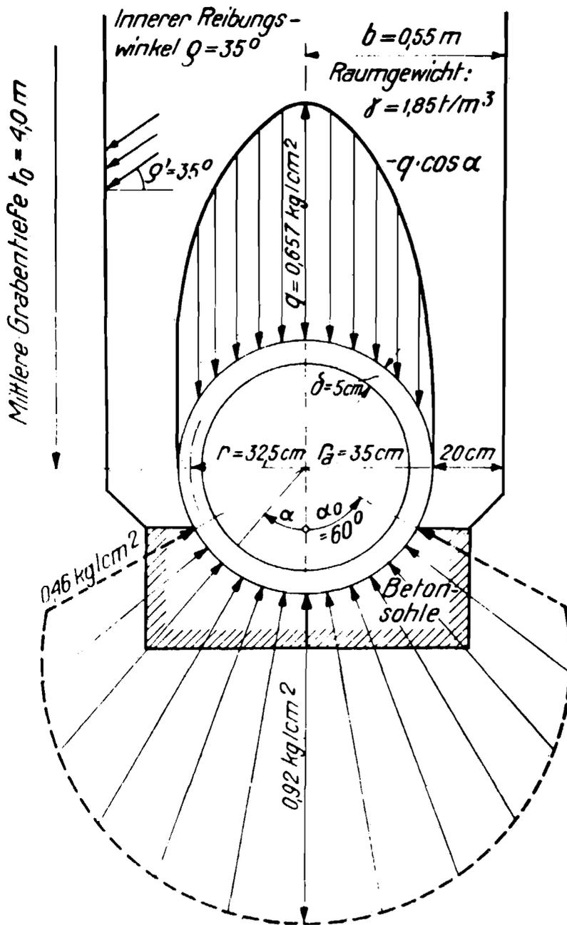
Erdbelastung einer Zementrohr-Grabenleitung in 4 m Tiefe
