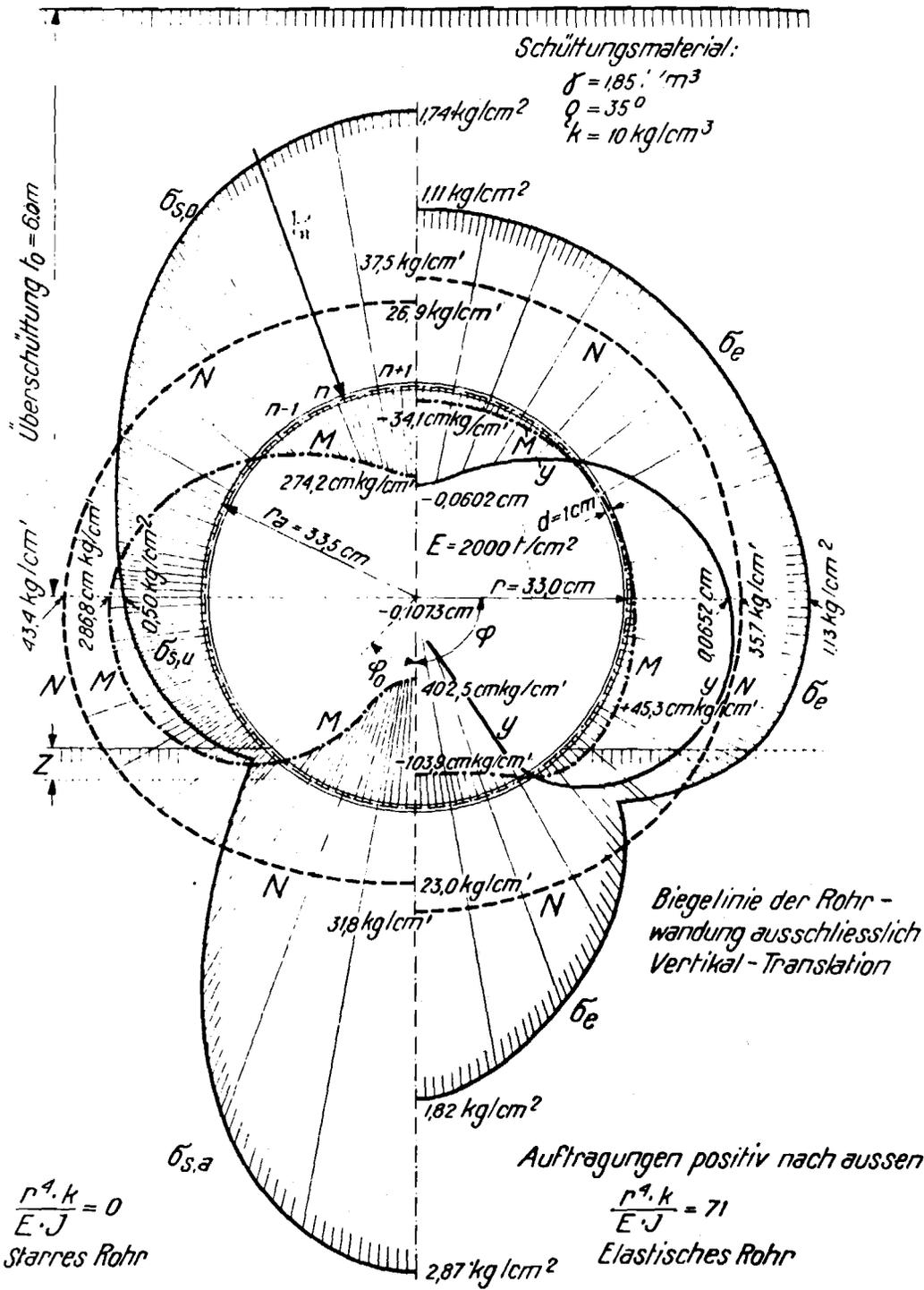
Erdbelastung und -Beanspruchung eines Eisen-Rohres von 66 cm Durchmesser unter einer Überschüttung von 6 m
