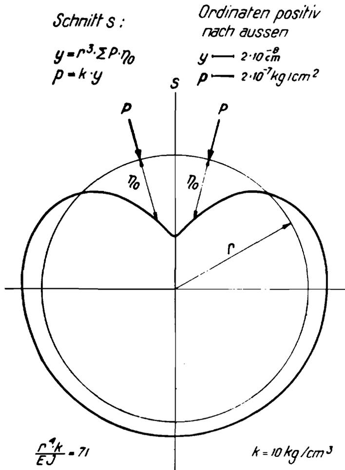
Einflußlinie für die elastische Bettung am radial belasteten Rohr.
