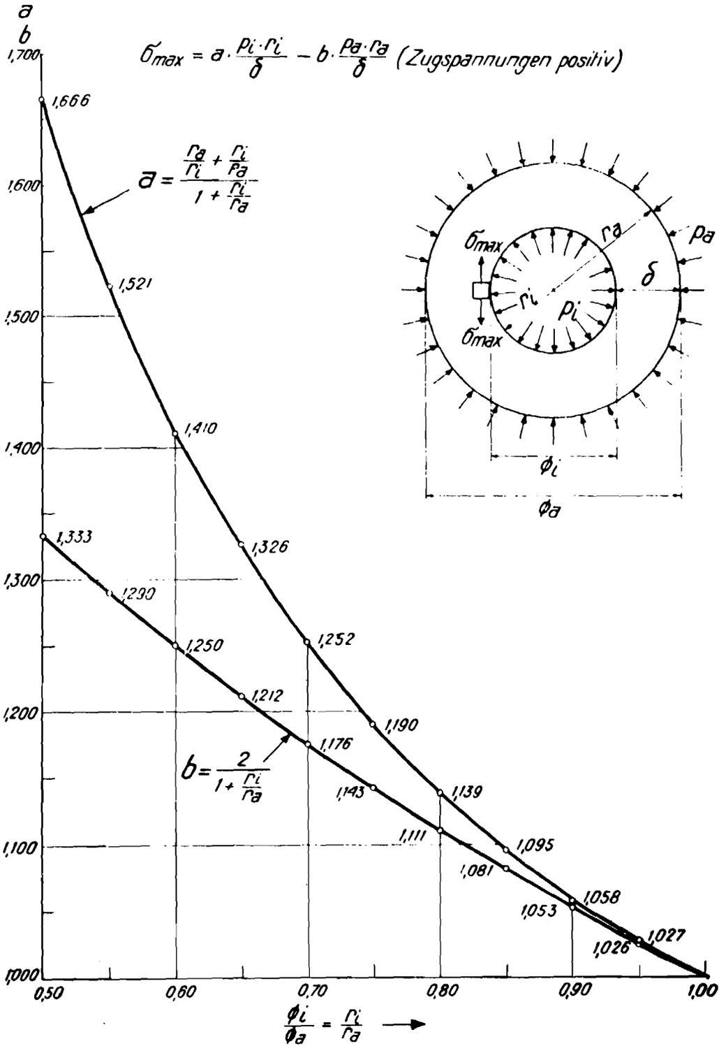
Maximalspannung, nach Lamé, an der Innenseite dicker Rohrwandungen
