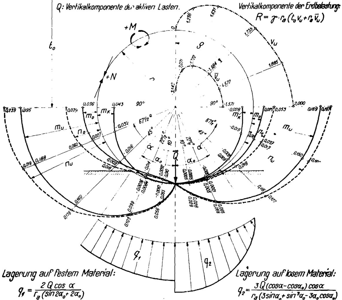
Fig. 69. Vertikalkomponente der Erdbelastung (Fig. 66) in Abhängigkeit vom Reibungswinkel  $\rho$ . (Kurven am oberen Viertel rechts)
