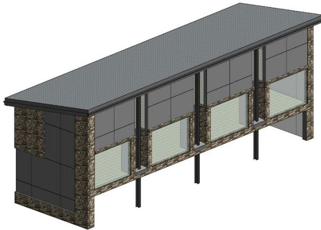
**Figure 5.2 : Bâtiment en bois avec irrégularité de rigidité verticale due à de grandes ouvertures au rez-de-chaussée**
