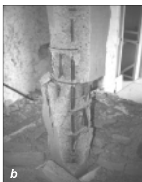
Figure 1. Vue a) d'un poteau en béton à résistance normale et b) d'un poteau en béton haute résistance après des essais de tenue au feu
