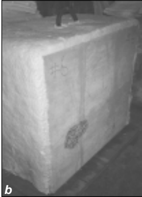
Figure 5. Vue de blocs en béton haute résistance exposés pendant deux heures à un feu d'hydrocarbures : a) bloc sans fibres de polypropylène; b) bloc avec fibres de polypropylène
